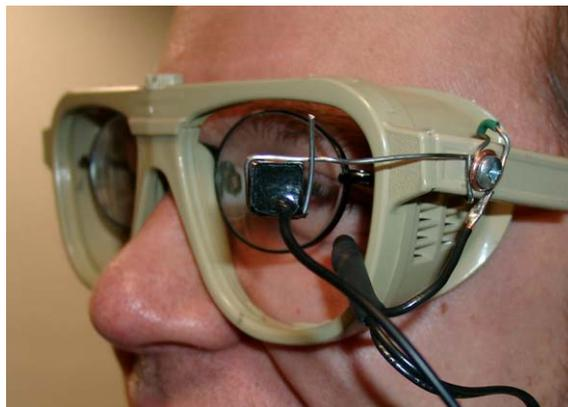
Abbildung 28: Eye-Tracker Befestigung I
