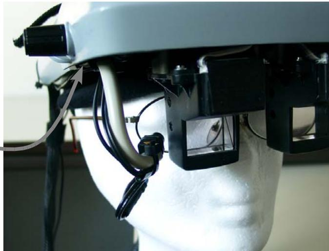
Abbildung 30: Eye-Tracker Befestigung II (vorne)
